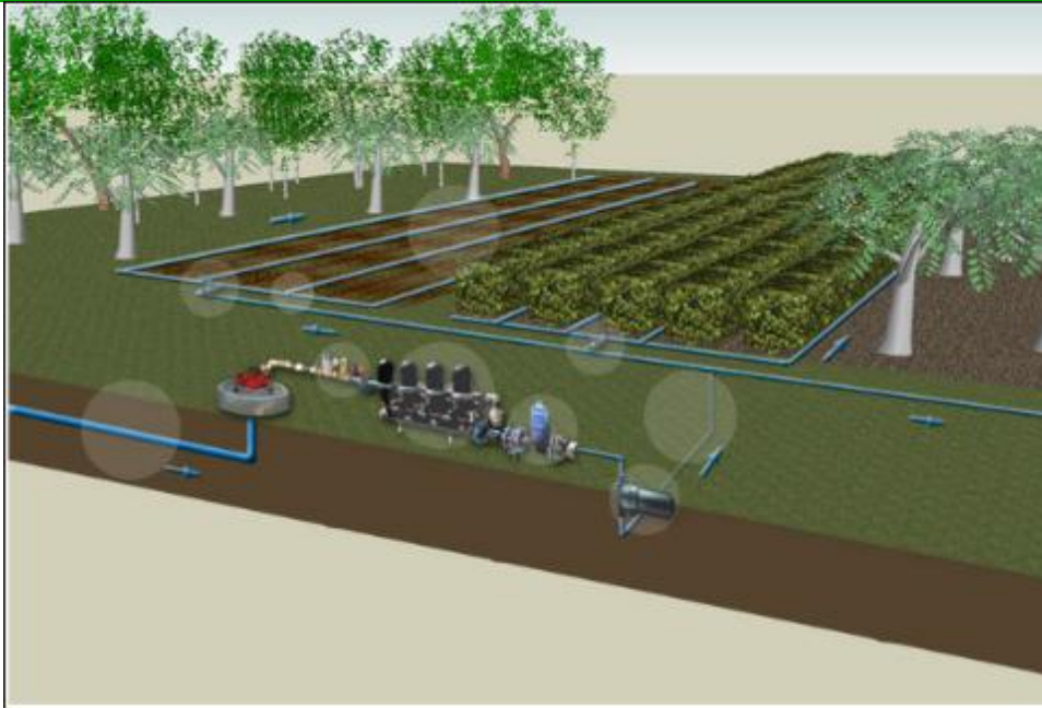
Profil d'un réseau de distribution d'eau sur un périmètre irrigué type goutte à goutte
